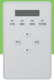
蓄電システムをグリーンモードに変更したい場合は、蓄電システム用ゲートウェイ KP-GWBT-Aを操作します。
